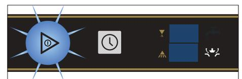
Wenn das Abpumpen abgeschlossen ist schaltet sich die Maschine automatisch aus und die Beleuchtung der Taste erlischt
