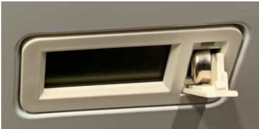
Nach vollständiger Öffnung des Batteriefachs, die Batterie entnehmen und diese austauschen:
