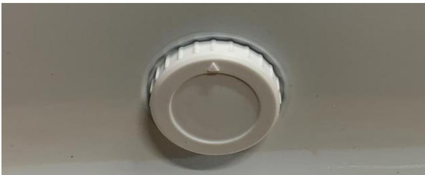
Dieser ist zu Reinigungszwecken wie abgebildet rauszuziehen und um 180° nach unten zu drehen, sodass das abgebildete Loch nach unten zeigt.
