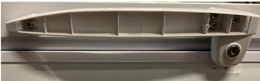
Abschließend nun alle vier Schrauben bis zum Widerstand festdrehen.
