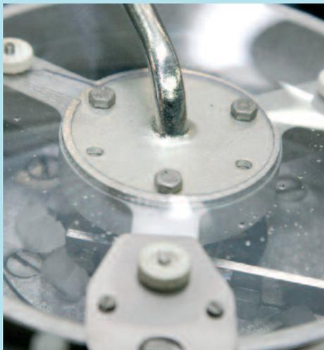
Gefrierzylinder mit Förderschnecke und Presskern.
