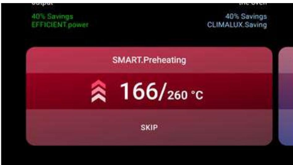
UNOX empfiehlt hierfür die Verwendung der automatischen Vorheizfunktion SMART.Preheating, die die Vorheizzeit und -temperatur selbstständig einstellt; sie berücksichtigt auch den Wärmeverlust beim Öffnen der Tür und wird beim Wechsel von einer Phase in die andere aktiviert, wobei der Garraum an die neuen Phasenparameter angepasst wird.
