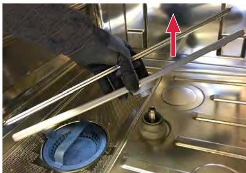
Den Düsen-einsatz anstelle der unteren Spülarme auf die Spülachse aufsetzen.
